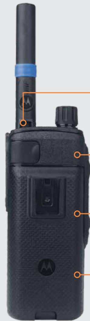
Conector para antena externa
