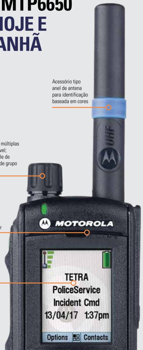
Acessório tipo anel de antena para identificação baseada em cores
